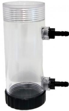
Célula de flujo que permite la recogida de muestras y el control de campo de agua dulce y marina cuando se usa con el medidor multiparamétrico HI9829 y una sonda compatible en una estación de monitoreo de flujo fijo con una bomba. La celda de flujo encierra la sonda durante la recogida de muestras y el monitoreo de campo, protegiendo la sonda de los desechos y las condiciones de agua irregulares. La célula de flujo es adecuada para control de campo ambiental y muestreo.
