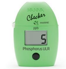
El medidor de bolsillo de Fósforo en agua marina, Checker HANNA HI736, es un colorímetro digital para realizar test de fósforo. El checker de Fósforo Agua Marina, HI736, se suministra con cubetas con tapa (2), reactivo para 6 tests, batería, instrucciones y guía rápida de uso.
