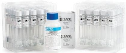
Los viales HI94758B-50 son reactivos pre-dosificados que siguen la adaptación del método **EPA 365.2** y Métodos estándar para el examen de aguas y aguas residuales, 20<sup>a</sup> edición, 4500-P E, método del ácido ascórbico para la determinación de fósforo ácido hidrolizable. Los reactivos se fabrican en nuestras instalaciones con tecnología puntera y se encuentran claramente marcados con número de lote y fecha de vencimiento.
