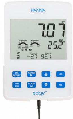
El HI2002 es un innovador pH-metro que ofrece precisión y versatilidad con el precio más competitivo. Además de pH puede medir potencial redox (ORP) con el electrodo ORP opcional adecuado, reconociendo automáticamente el sensor digital conectado, sus datos de calibración y número de serie. Puede utilizarse como equipo de sobremesa, pared o tableta portátil.
