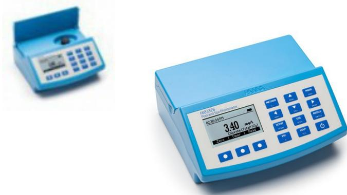
El HI83326 es un fotómetro multiparámetro compacto para uso en piscinas y spas. Este medidor tiene 12 diferentes métodos programados que miden 11 parámetros clave de calidad del agua. Cuenta con sistema de verificación propio con sistema CAL check™ a través de la utilización de patrones. Además, al mismo tiempo cuenta con la posibilidad de conectar un electrodo digital de la serie edge de HANNA para poder convertirlo en un pHmetro.
