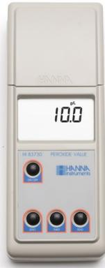
El fotómetro portátil HI83730 para la determinación del valor de peróxido para aceites y grasas combina precisión y facilidad de uso en un diseño ergonómico y portátil. Un usuario puede determinar con precisión el valor de peróxido dentro de un rango de 0,0 a 25,0 meq de O<sub>2</sub> / kg usando los reactivos listos para usar HI83730-20.
