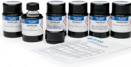
El kit de patrones calibración "CAL CHECK" proporciona una solución simple para verificar el fotómetro de análisis de aguas potables y aguas residuales HI83399. Este conjunto de estándares de alta calidad se suministra con un certificado de análisis que proporciona el número de lote, los valores de referencia y la fecha de caducidad.
