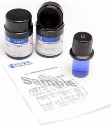
Los patrones calibración "CAL CHECK" trazable a NIST de Cobre rango alto HI96702-11 proporcionan una solución simple para calibrar y validar el fotómetro portátil de cobre de alto rango HI96702. Este conjunto de estándares entrega con un certificado de análisis, en el cual se proporciona el número de lote, los valores de referencia y la fecha de caducidad para la trazabilidad al certificar el fotómetro de alto rango de cobre.
