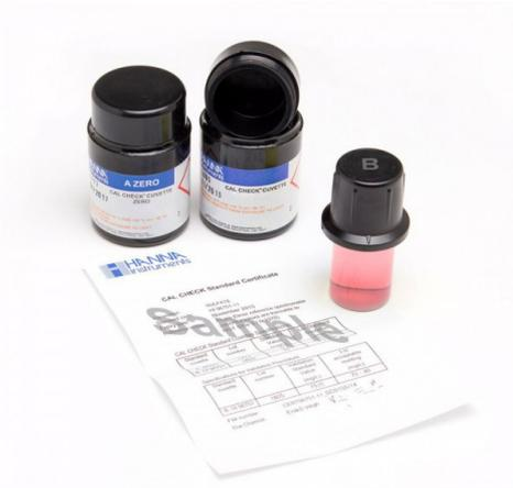
Los kit de patrones calibración "CAL CHECK" trazable a NIST de Dióxido de Cloro HI96738-11 proporcionan una solución simple para calibrar y validar el fotómetro portátil compatible con HI96738. Este conjunto de estándares de alta calidad se suministra con un certificado de análisis que proporciona el número de lote, los valores de referencia y la fecha de caducidad para la trazabilidad al certificar el fotómetro de dióxido de cloro compatible.
