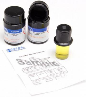
Los patrones calibración "CAL CHECK" trazable a NIST de Dureza Magnésica, HI96719-11 son estándares utilizados con medidores de magnesio y dureza total. Estos estándares proporcionan una solución simple para calibrar y validar fotómetros portátiles compatibles. Este conjunto de estándares de alta calidad se entrega con un certificado de análisis que proporciona el número de lote, los valores de referencia y la fecha de caducidad para la trazabilidad al certificar los fotómetros de dureza.
