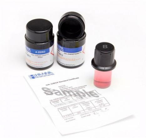
Los patrones calibración "CAL CHECK" trazable a NIST de Hidracina HI96704-11 proporcionan una solución simple para calibrar y validar el fotómetro portátil HI96704. Este conjunto de estándares de alta calidad se entrega con un certificado de análisis que proporciona el número de lote, los valores de referencia y la fecha de caducidad para la trazabilidad al certificar el fotómetro de hidracina compatible.
