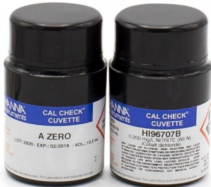
Los patrones de calibración "CAL CHECK" trazable a NIST de Nitritos rango bajo HI 96707-11 proporcionan una solución simple para calibrar y validar el fotómetro portátil HI96707. Este conjunto de estándares de alta calidad se entrega con un certificado de análisis que proporciona el número de lote, los valores de referencia y la fecha de caducidad para la trazabilidad al certificar el fotómetro de nitrito compatible.
