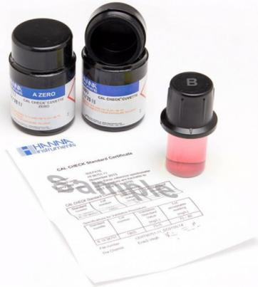
Los kit de patrones calibración "CAL CHECK" trazable a NIST de Potasio HI96750-11 proporcionan una solución simple para calibrar y validar el fotómetro portátil de potasio HI96750 compatible. Este conjunto de estándares de alta calidad se suministra con un certificado de análisis que proporciona el número de lote, los valores de referencia y la fecha de caducidad para la trazabilidad al certificar fotómetros de potasio compatibles
