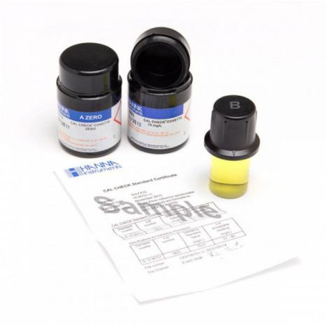
Los kit de patrones calibración "CAL CHECK" trazable a NIST de Sílice HI96770-11 proporcionan una solución simple para calibrar y validar el fotómetro portátil de alto rango de sílice HI96770. Este conjunto de estándares de alta calidad se suministra con un certificado de análisis que proporciona el número de lote, los valores de referencia y la fecha de caducidad para la trazabilidad al certificar el fotómetro HI96770.
