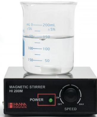
Agitador magnético compacto y ligero con una cubierta de acero inoxidable AISI 316.
