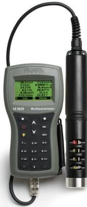
El HI9829 es un medidor multiparámetro portátil resistente al agua que mide y registra hasta 14 parámetros diferentes del agua; pH, ORP, conductividad, oxígeno disuelto, turbidez y temperatura (opcional: amonio, cloruro, nitrato) a través de una sonda multisensor. Medidor simple de configurar y fácil de usar.
