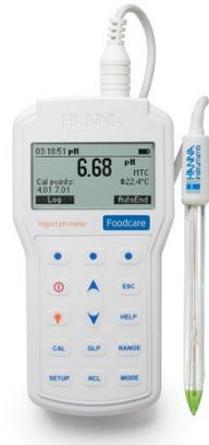
El HI98164 es un medidor de pH portátil, robusto, resistente al agua que mide el pH y la temperatura utilizando el electrodo de pH FC2233, específico para mediciones en yogur. Este medidor profesional e impermeable cumple con los estándares IP67.
