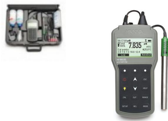
El HI98191 es un medidor de pH, ORP / ISE resistente y portátil con el rendimiento y las características de un medidor de sobremesa. Este medidor profesional e impermeable cumple con los estándares IP67 y mide el pH, el ORP, el ISE y la temperatura.
