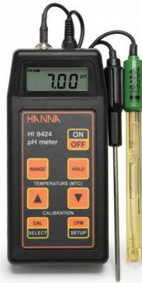
El HI8424 es un medidor de pH, ORP (o potencial REDOX) y temperatura compacto, impermeable y portátil. El medidor presenta calibración automática en uno o dos puntos, así como la compensación automática de temperatura (ATC) cuando se conecta la sonda de temperatura.
