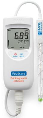
El pHmetro HI99192 está diseñado para medir el pH de las aguas potables. La sonda FC2153 tiene cuerpo de vidrio, punta de vidrio esférica y triple unión de cerámica, lo que la hace ideal para realizar medidas de pH en agua potable y otros líquidos de baja fuerza iónica.
