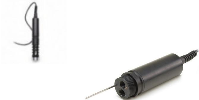
El HI7698196 es una sonda de pH / oxígeno disuelto / Temperatura a utilizar con el medidor portátil multiparamétrico HI98196. Los sensores son reconocidos automáticamente por la sonda y el medidor cuando están conectados. Su diseño robusto e impermeable lo hace ideal para uso en el campo.
