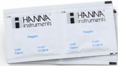
Este reactivo es necesario para realizar las medidas con el Medidor de bolsillo Checker HI762 de Cloro libre rango ultra bajo
