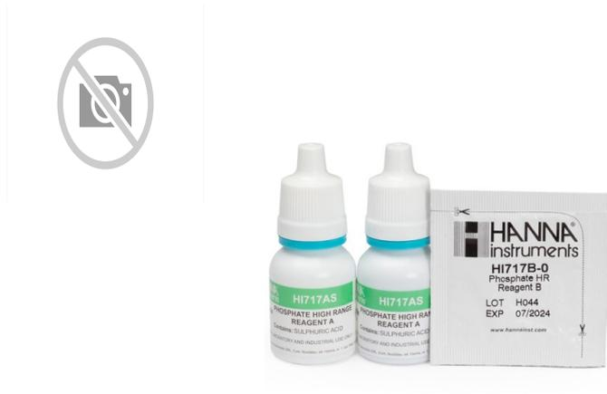
Este reactivo es necesario para realizar las medidas con el Medidor de bolsillo Checker HI717 de Fosfatos Rango alto
