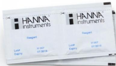
HI93714-0x son reactivos en polvo para la determinación colorimétrica de Cianuro (0,000 a 0,200 mg/L). Estos reactivos se pueden emplear en fotómetros de sobremesa y portátiles de Hanna Instruments.
