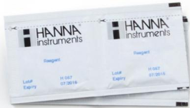
HI93721-0x son reactivos en polvo para la determinación colorimétrica de Hierro rango alto (0,00 a 5,00 mg/L). Estos reactivos se pueden emplear en fotómetros de sobremesa y portátiles de Hanna Instruments.
