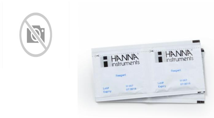
HI96770-01 son reactivos en polvo para la determinación colorimétrica de Sílice rango alto (0 a 200 mg/L SiO<sub>2</sub>) ,100 test. Estos reactivos se pueden emplear en fotómetros de sobremesa y portátiles de Hanna Instruments.
