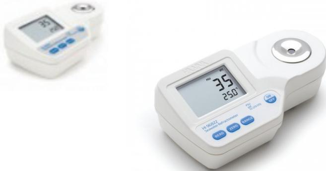
El medidor HI96822 es un refractómetro digital robusto y portátil diseñado para medir la salinidad del agua de mar natural o artificial. La pantalla del refractómetro HI96822 muestra resultados en tres unidades de medida: unidades prácticas de salinidad (PSU), salinidad en partes por miles (ppt) y gravedad específica (SG (20/20)).
