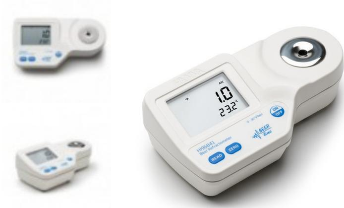
El refractómetro digital de Hanna para la elaboración de cerveza HI96841 mide el contenido de azúcar del mosto y lo convierte en ° Plato con solo presionar un botón. El refractómetro HI96841 es resistente para el uso en un entorno de elaboración, rápido (respuesta de 1,5 segundos), fácil de usar / limpiar y con una precisión de  $\pm 0.2$  ° Plato con compensación de temperatura automática.
