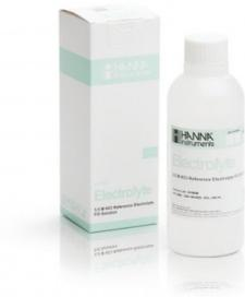
Solución de relleno 3.5M de KCl para electrodos de pH y ORP, específicamente fabricada para electrodos de doble unión. El nivel de electrolito en los electrodos rellenables debe verificarse antes de realizar cualquier medición. Si el nivel es bajo, rellene con la solución electrolítica adecuada para asegurar un rendimiento óptimo. Este sencillo mantenimiento ayuda a garantizar una presión adecuada para promover el flujo del electrolito de referencia en la muestra que se está midiendo.
