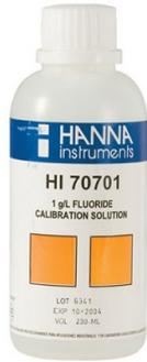
HI70701M es una solución estándar de 1 g / L de fluoruro que se utiliza para calibrar el electrodo selectivo de iones de estado sólido de fluoruro (ISE).
