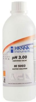
Solución tampón de pH de 3,00. Esta solución de tampón de pH 3,00 le permite calibrar su sistema de medición en el rango de pH ácido y colocar sus muestras ácidas entre corchetes utilizando un segundo valor a pH 4,01 o cercano a pH 7,01
