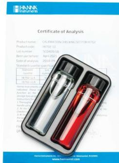
El HI702-11 es un conjunto de verificación de calibración que permite al usuario de manera sencilla validar el *Checker de cobre de rango alto HI702 (0,00 a 5,00 ppm)*. Se suministra con certificado de análisis que proporciona: número de lote, código de producto y fecha de caducidad.
