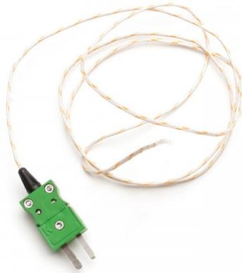
Es una sonda de temperatura termopar tipo K, de hilo, vaina flexible, sin asa y sensor de cables expuestos. Diseñada para acceder a lugares de difícil acceso.
