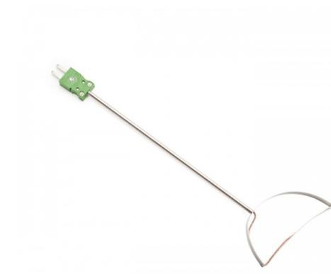
Es una sonda de temperatura termopar tipo K con cuerpo de acero inoxidable para mango HI766HD. Está especialmente diseñada para tomar medidas en superficies convexas y rodillos móviles.
