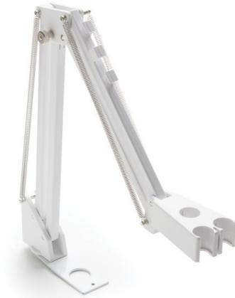
Soporte que brinda mayor estabilidad y flexibilidad y sostiene hasta 3 electrodos en cualquier posición para usar con los medidores de tabletas de la serie edge<sup>®</sup>.
