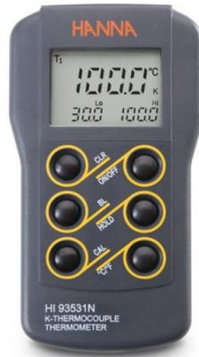
El termómetro para termopar Tipo K - HI93531 es un termómetro digital a prueba de agua. Este medidor ofrece mediciones de temperatura de alta precisión utilizando una amplia variedad de sondas tipo K intercambiables. Todas las lecturas se muestran en la pantalla LCD fácil de leer junto con las temperaturas altas y bajas, las unidades de temperatura y un indicador de batería al encender el equipo.
