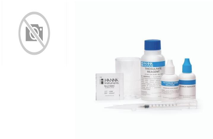
El HI38023 es un test kit que mide el cloro total mediante titulación yodométrica.
