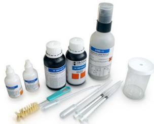
El HI38015 es un test kit que mide el cloruro por titración con nitrato de plata.
