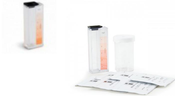
El HI3834 es un sencillo test kit que utiliza el método de la fenantrolina para medir el hierro total en el rango medio.
