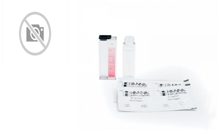
El HI3873 es un test kit que utiliza el método del ácido cromotrópico para medir el nitrito.
