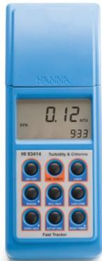
El HI93414 es un medidor portátil de turbidez y cloro de alta precisión. Este medidor es una combinación de un nefelómetro y un fotómetro para medir los parámetros más importantes en el agua potable: turbidez y cloro. El medidor se suministra completo con los estándares de turbidez primaria AMCO-AEPA-1 y los estándares de cloro secundarios rastreables NIST utilizados para la calibración y la verificación del rendimiento.
