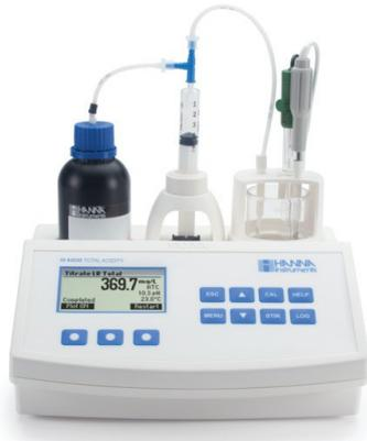
**HI84530** es un sistema rápido y sencillo para determinación de acidez en agua, fácil uso, rápido y económico. Basado en un método de valoración ácido-base, utiliza un método de análisis preprogramado optimizado con un algoritmo que determina la finalización de la reacción de valoración de forma potenciométrica con un electrodo de pH de cuerpo de vidrio.
