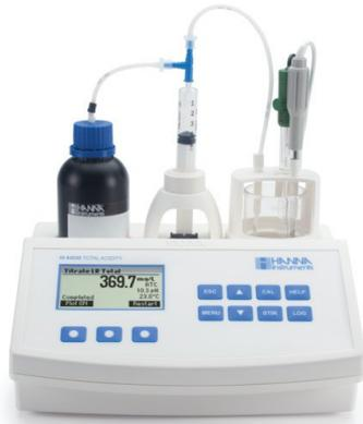
**HI84530** es un sistema rápido y sencillo para determinación de acidez en agua, fácil uso, rápido y económico. Basado en un método de valoración ácido-base, utiliza un método de análisis preprogramado optimizado con un algoritmo que determina la finalización de la reacción de valoración de forma potenciométrica con un electrodo de pH de cuerpo de vidrio.
