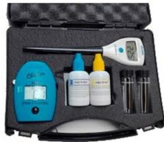
Conjunto en maletín de medidor de bolsillo de Cloro Libre Checker HI701 y Termómetro con sonda
