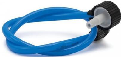
El HI900580S es un tubo dispensador de repuesto con ajuste para la bureta del sistema de valoración Karl Fischer HI903 y HI933. Los tubos están fabricados con PTFE duradero químicamente resistente y, cuentan con un mango exterior de poliuretano que bloquea la luz. El HI900580S se suministra con el tubo de valorante de PTFE, el tubo de protección azul y el bloqueo del tubo.
