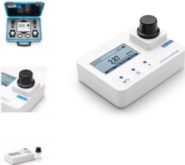
El fotómetro de Amonio de rango bajo HI97700 combina precisión y facilidad de uso en un diseño simple y portátil. Gracias al *Sistema Calcheck*, el fotómetro es calibrable y ajustable por el usuario.
