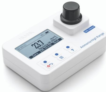
HI97733 es un fotómetro portátil para la medición de amonio de rango alto. Este equipo ofrece un sistema óptico avanzado que utiliza un detector de referencia y filtros de interferencia de banda estrecha para mediciones extremadamente rápidas y repetibles.
