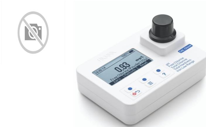
Fotómetro portátil calibrable de cloro libre y cloro total, hierro (rango bajo), dureza total y pH de la nueva Serie 97, HI97745. Fotómetro con sistema CALCHEK calibrable por el usuario, con nuevo diseño óptico para mejorar la repetitividad y rapidez de la medida.
