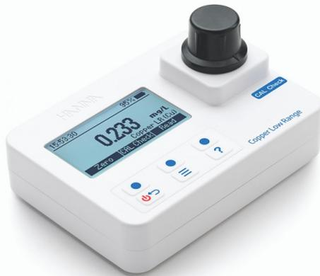
HI97747 es un fotómetro portátil para la medición de cobre de rango bajo. Este equipo ofrece un sistema óptico avanzado que utiliza un detector de referencia y filtros de interferencia de banda estrecha para mediciones extremadamente rápidas y repetibles.
