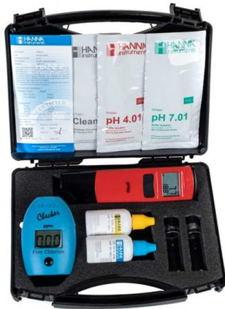
Conjunto en maletín de medidor de bolsillo de Cloro Libre Checker HI701 y Medidor de bolsillo de pH HI98107
